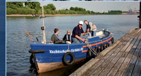
Unser „Arbeitspferd“ ist unser **Ausbildungsboot** für die Motorpraxis. Das robuste, ehemalige Ruder-Rettungsboot ist mit einem Dieselaggregat und Wellenanlage ausgerüstet und wird mittels Pinne gesteuert.
